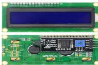
3-rasm. 16x2 LCD displeyi.
